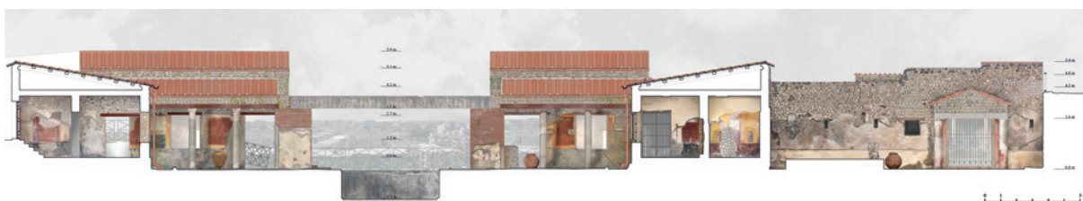
Fig. 14. Sezione A-A', con rilievo dei materiali aggiornato al 2019 (elaborazione grafica dell'autore).
