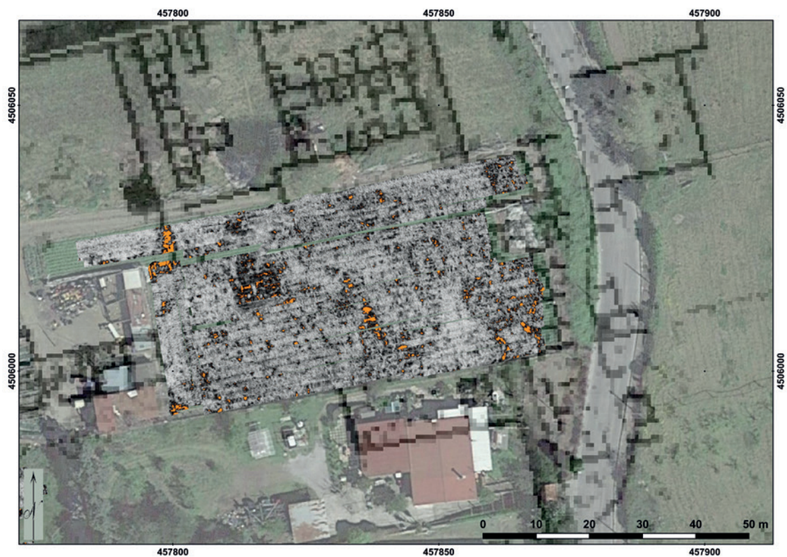
Fig. 14. Villa San Marco, indagini geofisiche 2021. Area Stabia2: slice radar profondità 1 m sovrapposta alla planimetria del Weber (1759).
